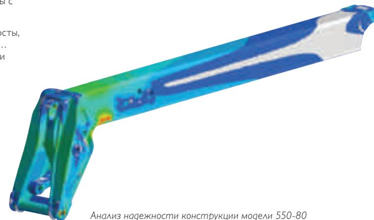
Анализ надежности конструкции модели 550-80
